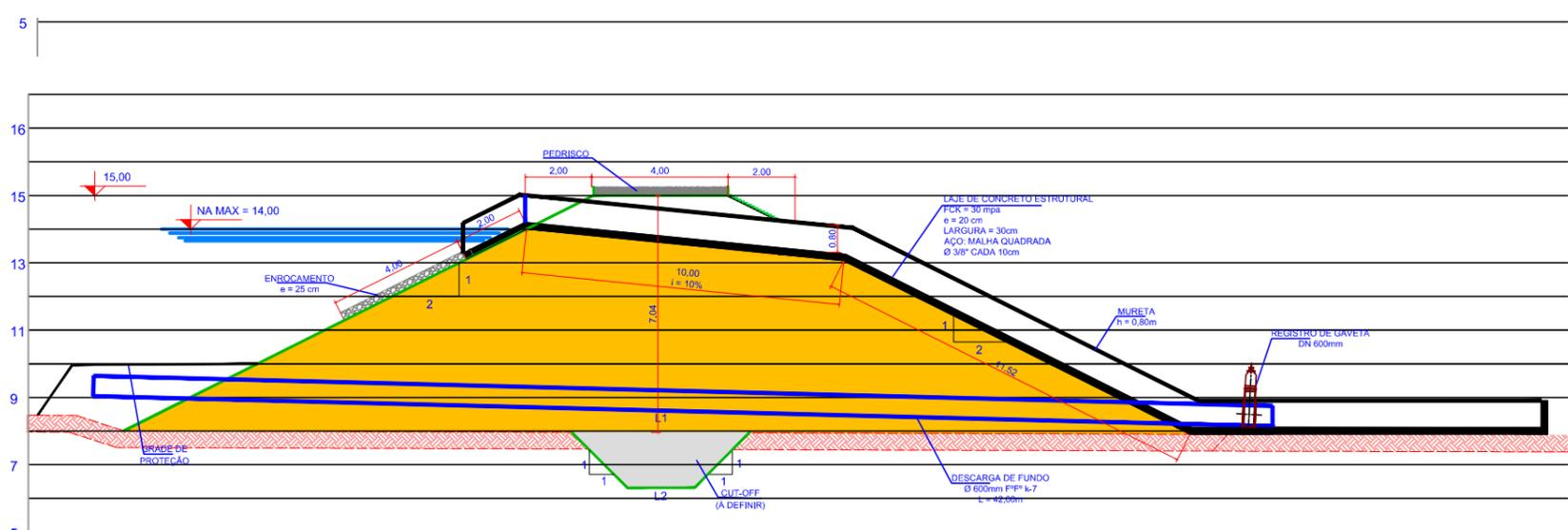
2 SEÇÃO TRANSVERSAL NO VERTEDOR DE CONCRETO
